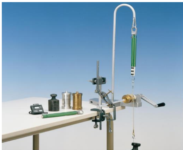
Фиг. 3. Експериментален модел: Механичен еквивалент на топлината.
