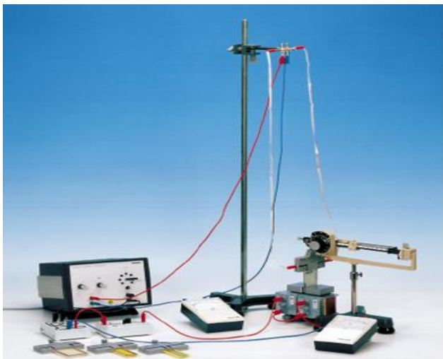
Фиг. 5. Сила, действаща върху проводник, по който протича ток.
