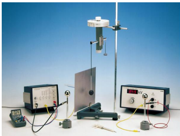
Фиг. 4. Експериментална установка за измерване на електростатичната сила на привличане, действаща върху сфера.
